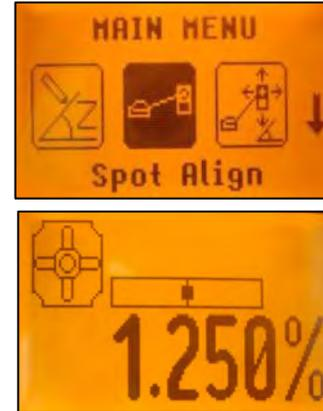
**Hinweis:** Das linke SF-Symbol blinkt, während ein weiteres SF-Symbol rechts auf der Anzeige die Strahlbewegung anzeigt, bis der Strahl auf dem SF803 zentriert ist.
