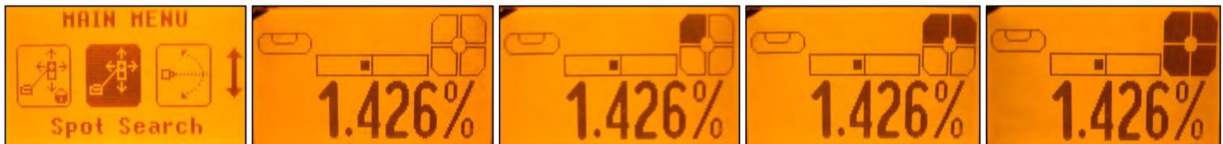
Die manuelle Punktsuche kann jederzeit durch kurzes Drücken der Taste **ESC** beendet werden.
