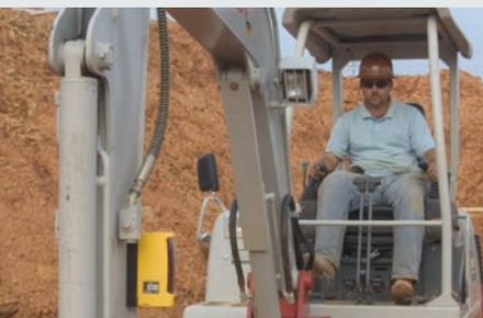
Laser-Displayempfänger von Spectra Precision® sorgen dafür, dass Sie weniger Zeit auf der Baustelle verbringen, und sich in der Kabine um die produktive Arbeit kümmern können. Die Displayanzeige hilft dem Maschinenführer, die gewünschte Höhe oder Tiefe ohne Messlattekontrolle einzuhalten und sorgt gleichzeitig für mehr Genauigkeit und Profit. Maschinennutzungszeit, Effektivität und Effizienz werden optimiert.
